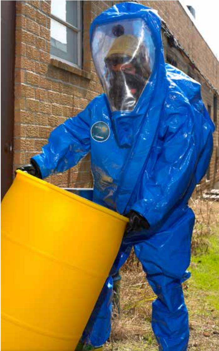
Overol estanco al gas de Tipo 1a. Se usa con aparato de respiración interno para protección frente a gases y vapores peligrosos.
