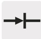
Prueba de diodos
